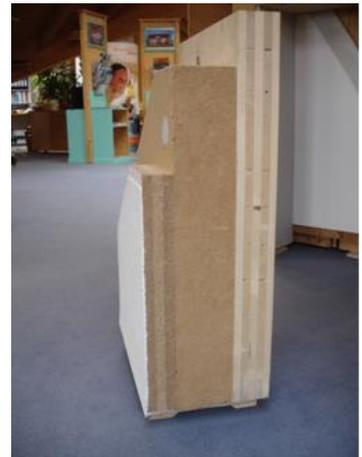
**3.3 „Klima-Wand“, MHM, ca.  $U = 0,19 \text{ W/m}^2\text{K}$  (auf Wunsch verbesserte Werte),  $R_w$  48 db, Phasenverschiebung 22,3 h, Wandstärke 34,57 cm, Wandaufbau von innen nach außen:**
